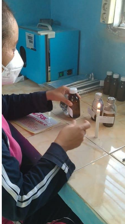
Gambar 3. 5 pemeriksaan sampel air dengan menggunakan Compact Dry EC
