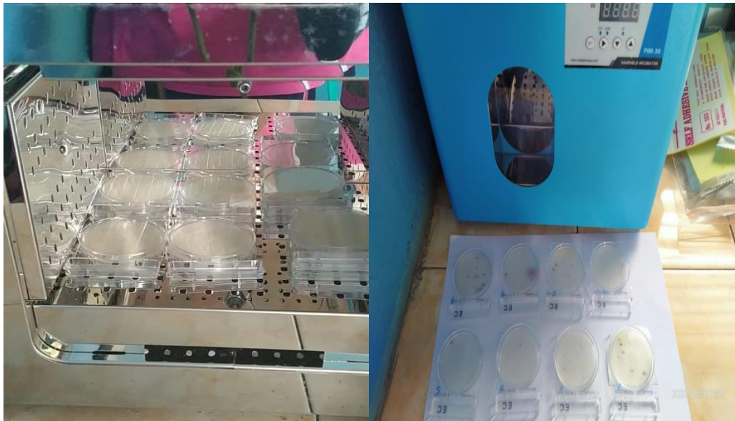
Gambar 3. 5 pemeriksaan sampel air dengan menggunakan Compact Dry EC
