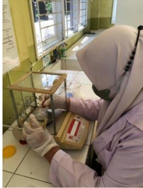
1. Ditimbang minyak VCO, minyak jarak, dan minyak zaitun lalu masukkan ke dalam beaker glass lalu pemanasan di atas *hotplate*
