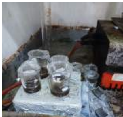
Gambar 11. Setelah ditimbang tambahkan \text{HNO}_3 5 ml dan \text{HCl} 5 ml, kemudian dipanaskan selama 30 menit dengan suhu 95^\circ celcius
