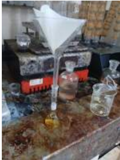
Gambar 13. Kemudian disaring menggunakan kertas saring whatman 41
