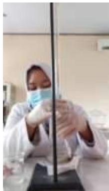
Gambar 29 Titrasi standarisasi bilangan peroksida
