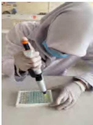
16. Menambahkan stop solution ke semua well
