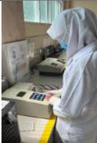
13. Melakukan pencucian sebanyak 5x dengan Elisa Washer
