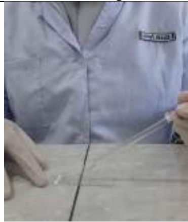
Sumber: Dokumen pribadi. Gambar 2.14 Dibuang bagian supernatan, kemudian mempipet 1 tetes endapan yang ada di dalam tabung reaksi diletakan di atas object glass .
