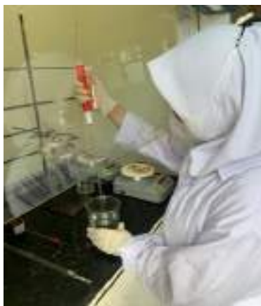
Pemipetan akuades dan \text{NaOH} 10% hingga larutan menjadi basa
