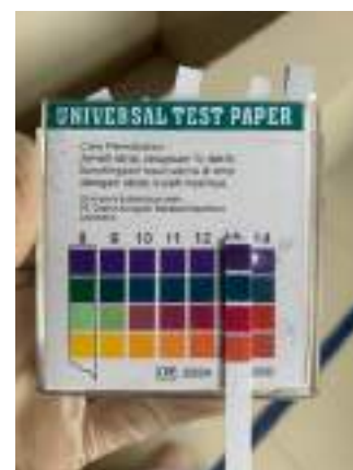
Pengecekan larutan dengan kertas pH
