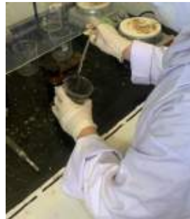
Hasil ekstraksi ditampung dan ditambahkan 15 tetes \text{H}_2\text{SO}_4
