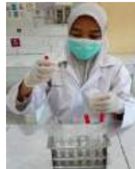
Gambar 10. Memisahkan bagian jernih dan endapan dengan pipet tetes
