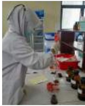
Gambar 23. Sampel Ditambahkan 10 mL HCl 10%
