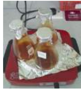
Gambar 27. Dipanaskan selama 30 menit dengan suhu 125-130^\circ\text{C}
