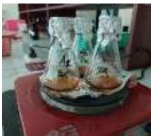
Gambar 37. Dipanaskan selama 30 menit dengan suhu 125-130°C.
