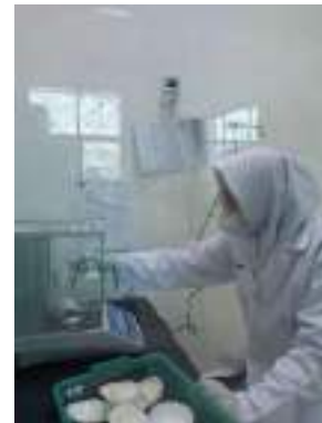
Gambar 53. Timbang kertas saring dan endapan hingga mendapatkan berat yang konstan.
