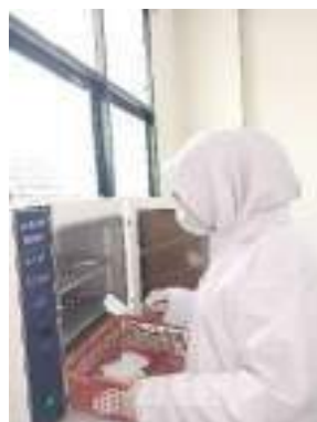
Gambar 28. Mengoven kertas saring selama 30 menit dengan suhu 100°C.
