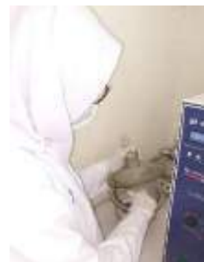
Gambar 29. Kertas saring didinginkan selama 10 menit dengan desikator.
