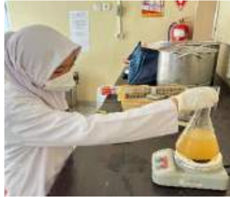
Gambar 2. Melarutkan media di hotplate.
