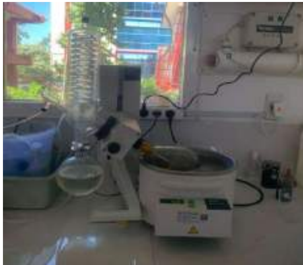
Proses evaporasi maserat menggunakan Rotary evaporator
