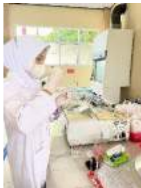
Gambar 17. Pembacaan panjang gelombang pada sampel dengan Spektrofotometri UV-Vis
