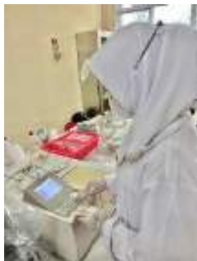
Gambar 16. Pembacaan panjang gelombang larutan baku pada Spektrofotometri UV-Vis
