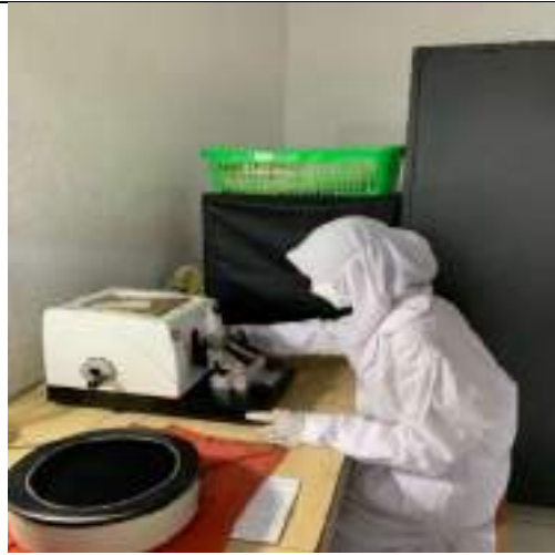
Gambar 1. Pemotongan Pita Jaringan di mikrotom
