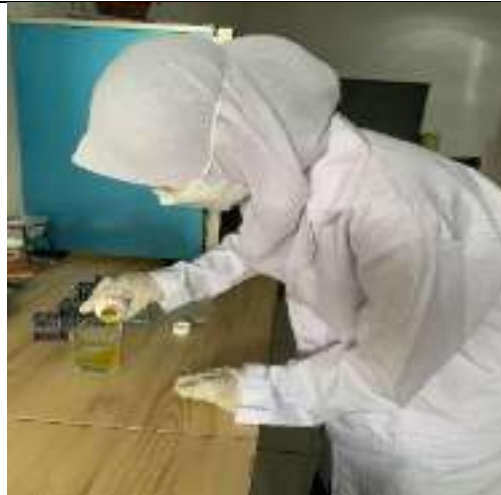
Gambar 5. Deparafinisasi Menggunakan Minyak Atsiri Kenanga Tanpa Pemanasan
