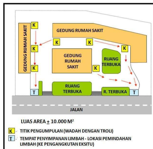
Gambar 2.11 Tata Letak Pengumpulan Limbah Medis (Sumber: PERMENLHK No.56 Tahun 2015)
