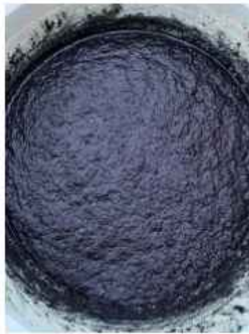
Proses perendaman arang serbuk kayu dengan menggunakan larutan H_3PO_4 (Asam Fosfat) selama 24 jam
