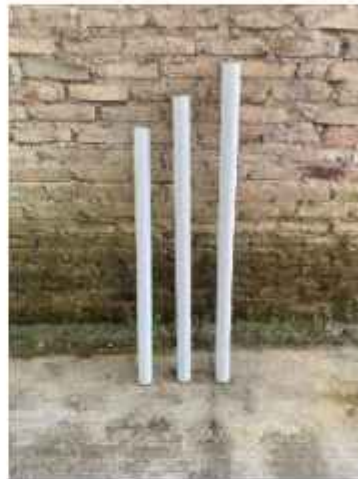
Pipa PVC yang telah selesai proses pemotongan
