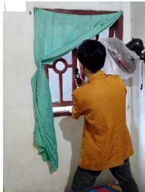
Pengukuran Laju Ventilasi
