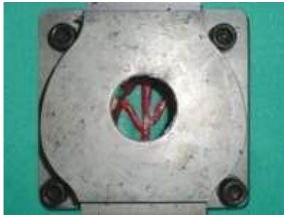
Gambar 2.17 Pemasangan Sprue (Singh & Gupta 2012, 303)
