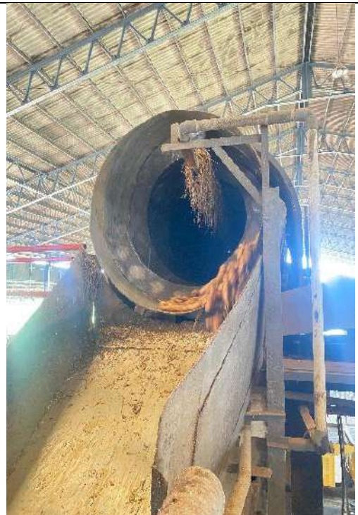
Proses pengupasan Kulit Singkong dengan Mesin Peeler
