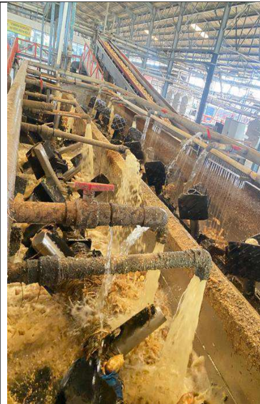
Pencucian singkong dengan mesin Washer
