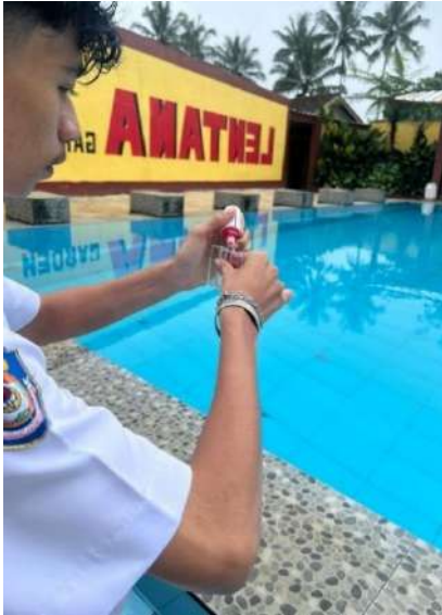
Pengecekan Kualitas air kolam renang sisa chlor dan ph
