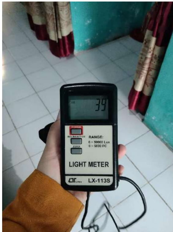
Pengukuran pencahayaan menggunakan lux meter
