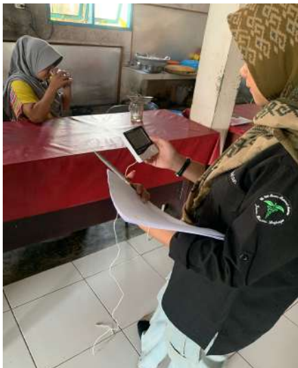
Pengecekan Kelembaban Dapur
