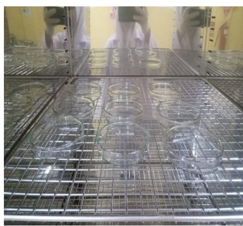
Cawan kosong di oven dengan suhu 105^{\circ}\text{C} selama 30 menit
