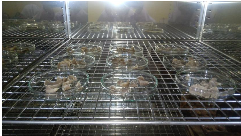
Kemudian cawan + sampel di oven dengan suhu 105°C selama 1 jam
