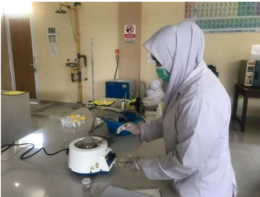
Proses memasukkan sampel ke dalam labu alas bulat lalu dilanjutkan dengan proses destilasi sampel.
