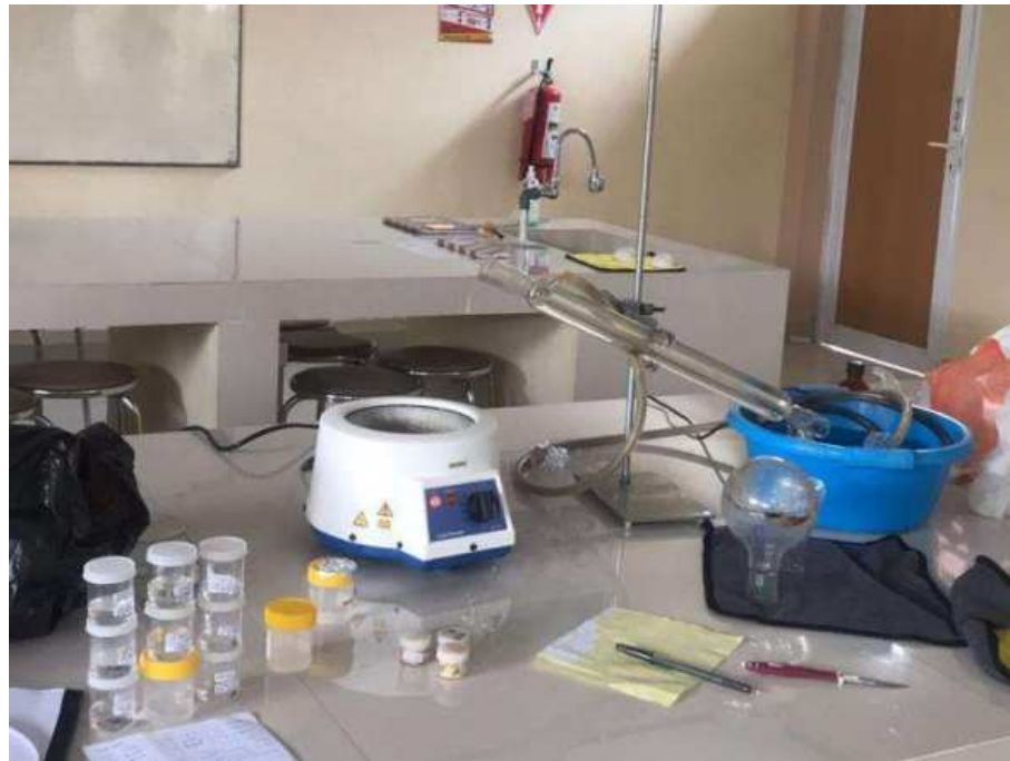
Rangkaian alat destilasi
