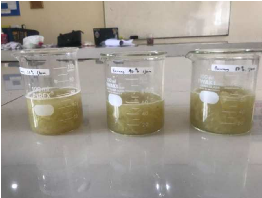
Perendaman ikan asin jambal roti dengan larutan bawang putih konsentrasi 30%, 40%, 50% dengan variasi waktu 30 menit, 40 menit dan 50 menit.
