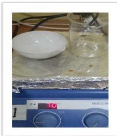
Dileburkan fase minyak dan fase air diatas hot plate dengan suhu 70^{\circ}\text{C}
