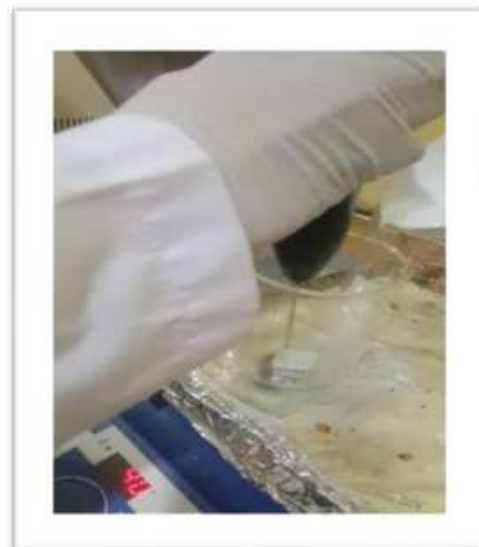
Dicampurkan fase air kedalam fase minyak aduk dengan hand blend sampai terbentuk korpus emulsi
