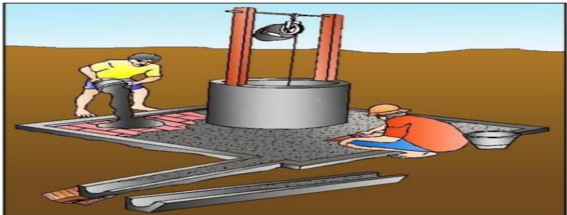
Gambar 5 : Lantai sumur dan saluran pembuangan air
