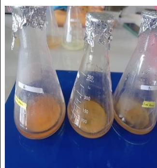
Gambar 18. Hasil pemanasan sampel B (Ada endapan putih)
