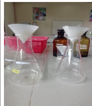
Gambar 15. Setelah 30 menit, larutan disaring dengan kertas whatman
