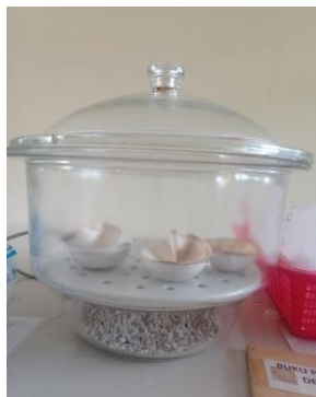
Gambar 25. Endapan didinginkan dalam desikator selama 5 menit
