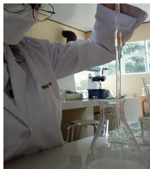
Gambar 16. Filtrat ditambah dengan 10 ml \text{NaNO}_2 10%, kemudian dipanaskan diatas hotplate 20-30 menit
