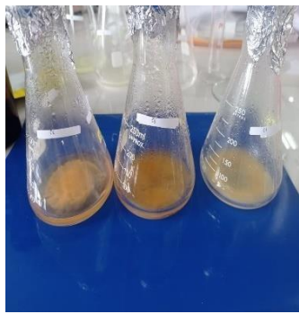
Gambar 19. Hasil pemanasan sampel C (Ada endapan putih)
