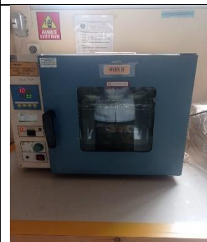
Gambar 24. Hasil endapan di keringkan dalam oven suhu 100°C selama 30 menit
