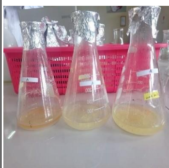
Gambar 17. Hasil pemanasan sampel A (Tidak ada endapan putih)
