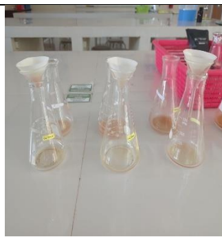
Gambar 23. sampel yang terdapat endapan putih disaring dengan kertas whatman
