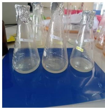
Gambar 20. Hasil pemanasan sampel D (Tidak ada endapan)
