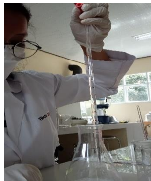
Gambar 14. Tambahkan 10 ml \text{BaCl}_2 10% kedalam Erlenmeyer tersebut, homogenkan dan diamkan selama 30 menit
