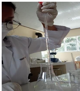
Gambar 13. Filtrat dimasukkan dalam Erlenmeyer dan ditambah dengan 10 ml HCl 10%
