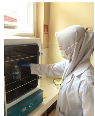
Inkubasi pada suhu 60°C selama 10 menit
