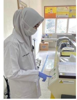
Sentrifugasi 3000 rpm selama 10-15 menit
