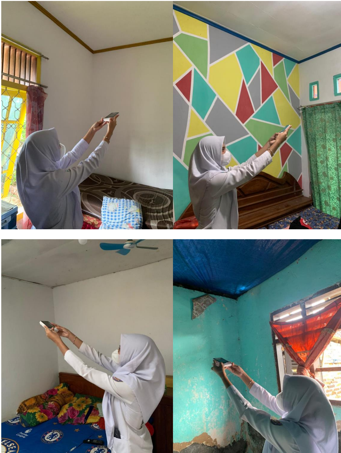
Pengukuran Kelembaban dan Suhu Menggunakan Alat Ukur Thermo Hygrometer di Rumah Penderita TB Paru di Wilayah Kerja Puskesmas Natar Kabupaten Lampung Selatan
