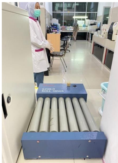
Gambar Blood Roller Mixer untuk homogenisasi sampel darah
