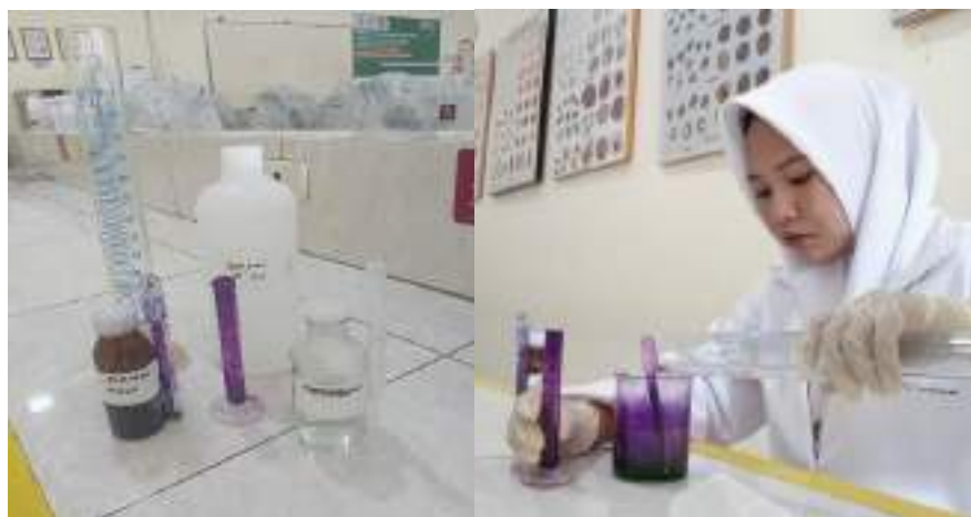
Gambar 3. Pembuatan larutan pengecatan giemsa 3% Di laboratorium parasitologi Jurusan Teknologi Laboratorium Medis Poltekkes Kemennkes Tanjung Karang
