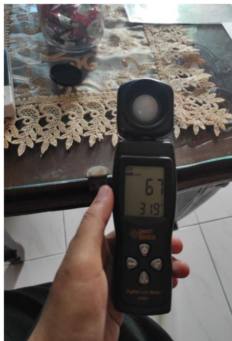
Pengukuran Pencahayaan Dengan Alat Ukur Lux Meter Pada Rumah Penderita Tb Paru di Wilayah Kecamatan Sukabumi Kota Bandar Lampung.
