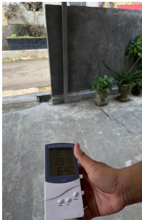
Pengukuran Kelembaban Dengan Menggunakan Alat Ukur Thermo Hygrometer Pada Rumah Penderita Tb Paru di Wilayah Kecamatan Sukabumi Kota Bandar Lampung
