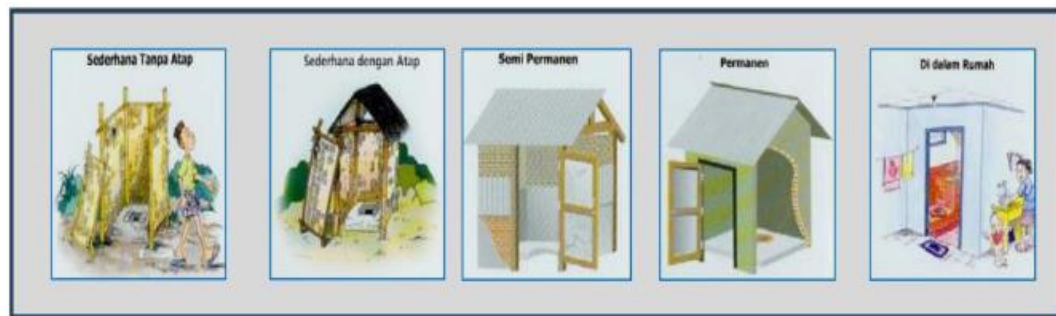
Gambar 1. Bangunan Atas Jamban (Dinding/Atap)
