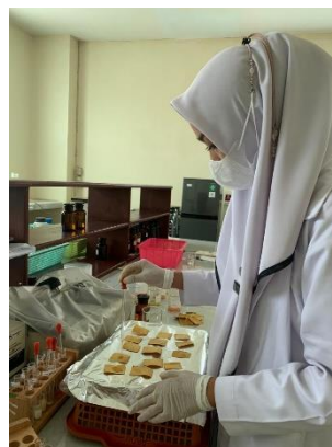
dilakukan uji kualitatif dengan cara meneteskan supernatan dikertas kurkumin
