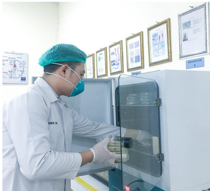
Keterangan : plate di masukan ke inkubator dengan suhu 37 0 C
