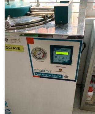
Gambar 6 Sterilkan media didalam autoklaf dengan suhu 121°C
