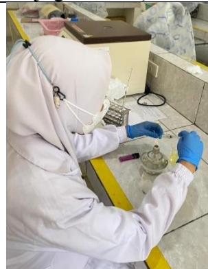
Gambar 28. Dimasukkan 1 ml putih telur ke dalam tabung reaksi
