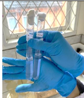
Gambar 37. Penyetaraan suspensi jamur Candida albicans dengan standar Mac Farland 0,5
