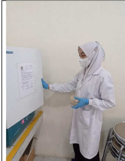
Gambar 40. Inkubasi media pada suhu 37°C selama 3x24 jam
