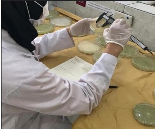
Gambar 24 Pengukuran diameter zona hambat
