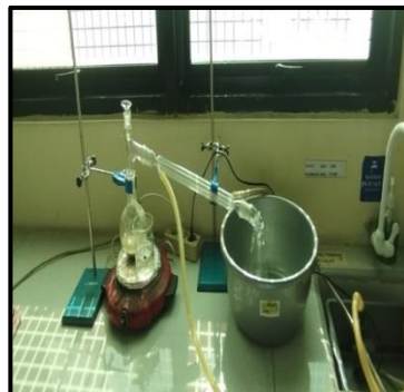
Seperangkat destilasi sederhana
