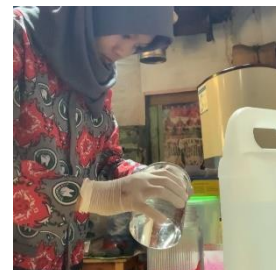
Menuangkan ethanol kedalam toples yang berisi bahan basah
