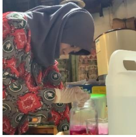
Mengaduk bahan selama 3 hari dengan waktu per 8 jam
