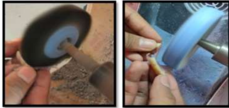
Gambar 2. 26 Polishing (a). Menghaluskan (b). Mengkilapkan (Sidik, 2022)
