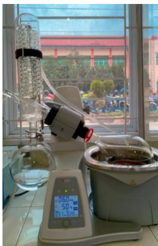
Pemekatan di rotary evaporator
