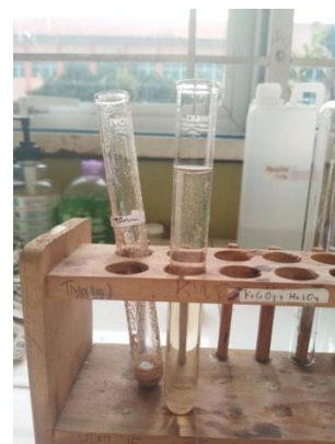
3. Filtrat diencerkan menggunakan aquades
