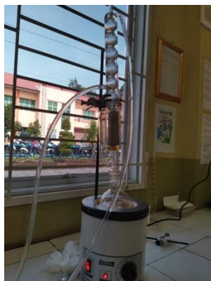
4. Proses ekstraksi menggunakan alat soxhlet pada suhu 70 °C
