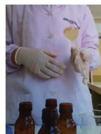
3. Kocok larutan induk dengan membolak-balikkan labu ukur
