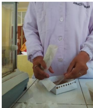
2. Simplisia yang akan diekstrak, dibungkus dengan kertas saring lalu ikat dengan tali kasur
