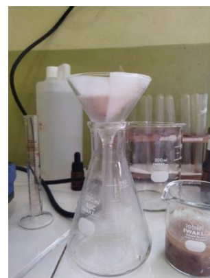
3. Penyaringan filtrat yang sudah dipanaskan
