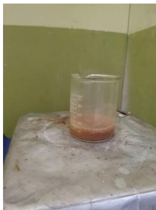
2. Pemanasan simplisia Cabai Jawa + 1 ml HCl 2N + 9 mL aquades
