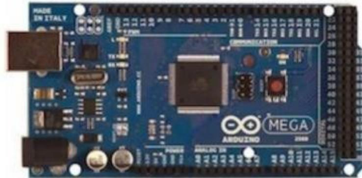
Gambar 2.4 Mikrokontroler Arduino MEGA
