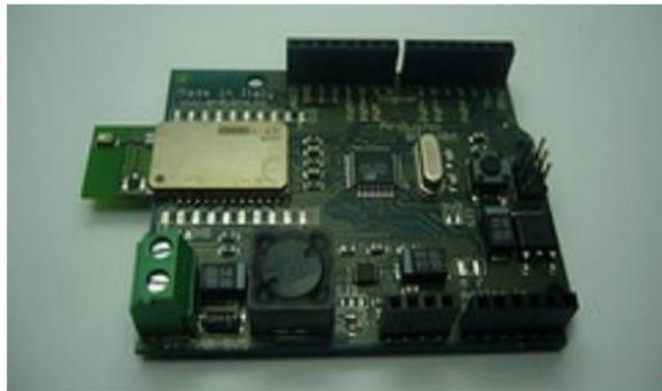
Gambar 2.7 Mikrokontroler Arduino BT
