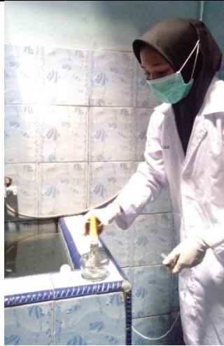
Gambar 1 Sterilisasi mulut botol pada sampel 8
