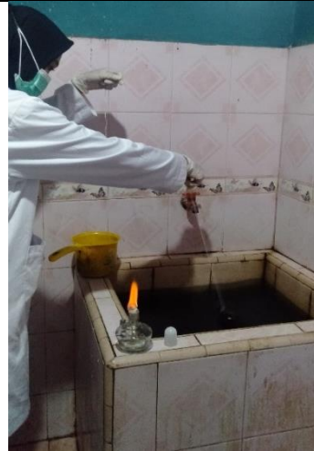
Gambar 2 pengambilan sampel air menggunakan tali pada sampel 23
