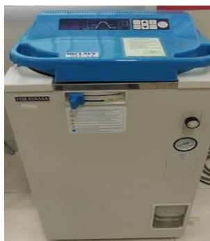
Gambar 5 Disterilkan media didalam autoklaf pada suhu 121°C selama 15 menit
