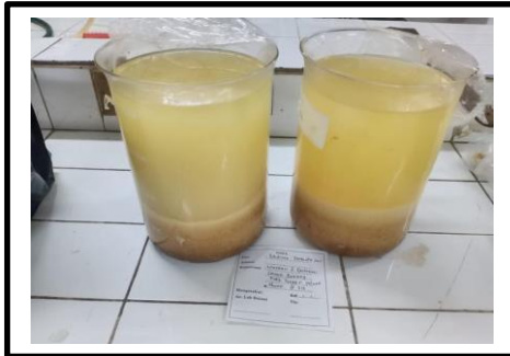
Perendaman serbuk simplisia Dengan etanol 96%
