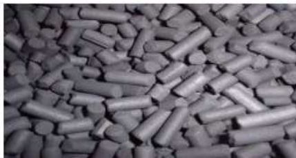
Gambar 2.4 Karbon Aktif Berbentuk Pelet (Sumber: Cahyo, 2015)
