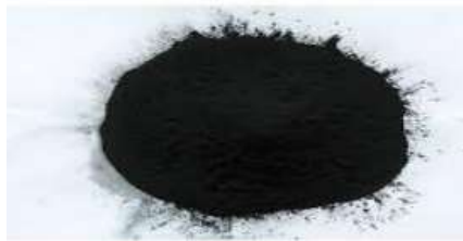
Gambar 2.2 Karbon Aktif Bentuk Serbuk (Sumber: Cahyo, 2015)
