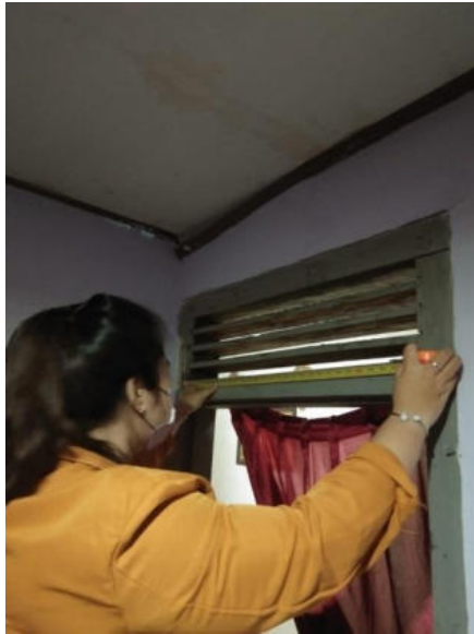
Pengukuran Luas Ventilasi
