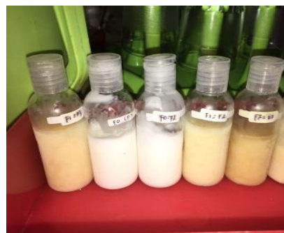
Uji cycling test dengan suhu 30°C selama 24 jam
