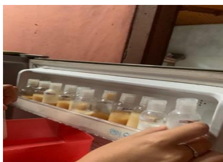
Uji cycling test dengan suhu 4°C selama 24 jam
